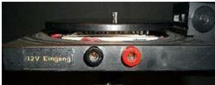
Obr. 5 Přípojky pro napájecí napětí 12-15 V / 8 A
