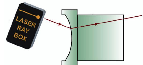
**E14b Prechod zväzku rovnobežných lúčov dutým guľovým rozhraním z opticky redšieho do opticky hustejšieho prostredia**
