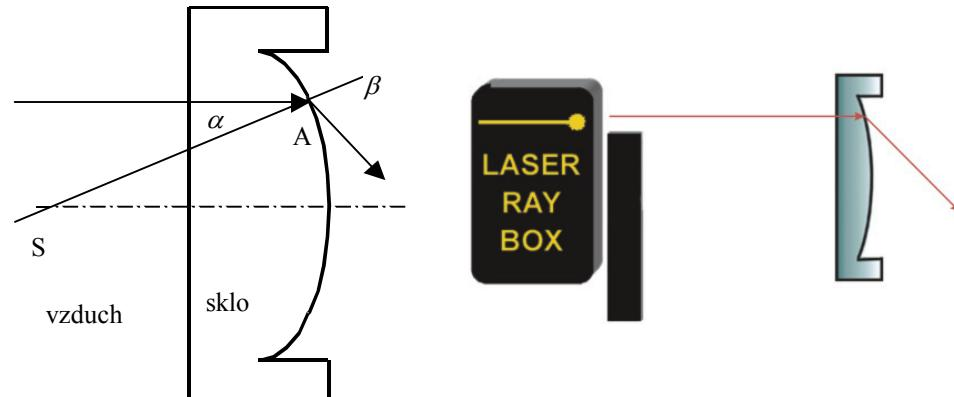
**E16b Prechod zväzku rovnobežných lúčov guľovým dutým rozhraním z opticky hustejšieho do opticky redšieho prostredia**
