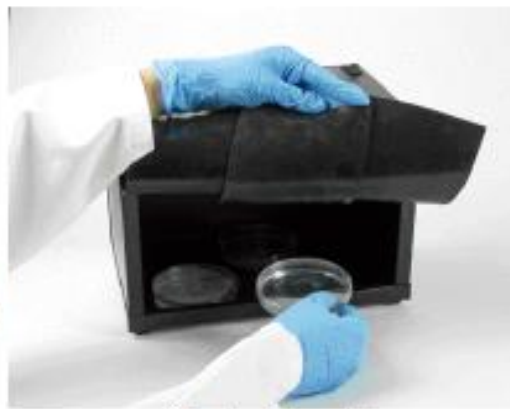
Použití komory pro ozáření mikroorganismů
