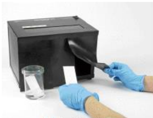
Použití komory pro vyvíjení TLC desek
