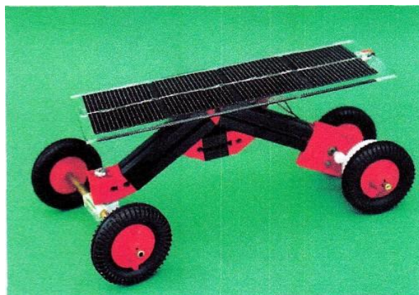
Solární automobil s vlastnoručně vyrobeným fotovoltaickým modulem
